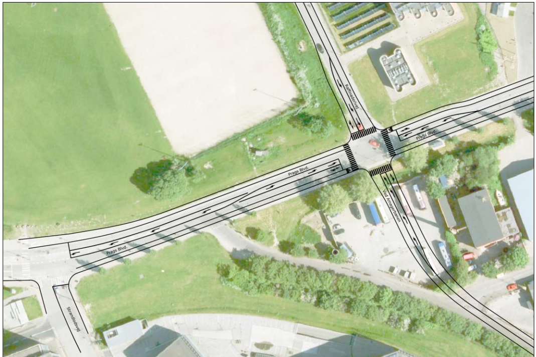
Figur 3. Principsskitse af udbygningen af krydset Prags Boulevard/Raffinaderivej fra 2015. 1 OBS! Hovedprojektet, der skal stå færdigt inden udgangen af 2019, adskiller sig fra den viste principsskitse.
